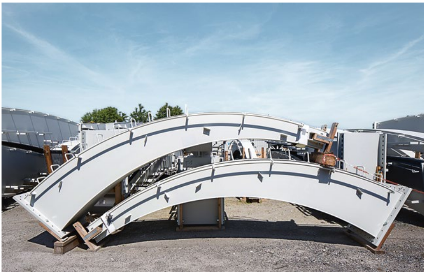
Der neue Masttyp wird aus Stahlplatten hergestellt. Diese werden gerollt und zusammenschweißt. So ergibt sich eine runde Mastform.
