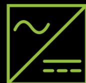
Schaltzeichen: Die Sinuskurve steht für Wechselstrom, die Doppellinie für Gleichstrom.
