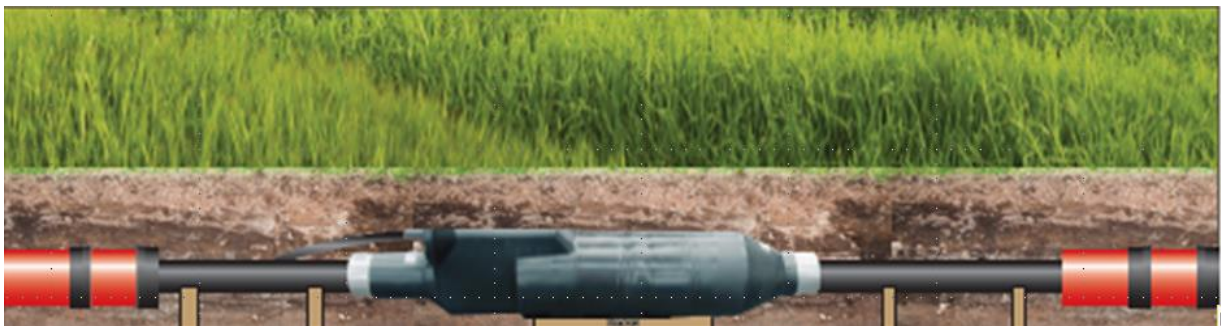
Abbildung 26: Darstellung Kabelmuffe
