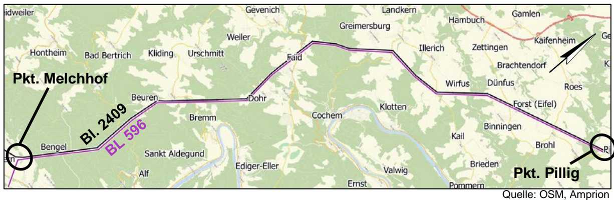
Abb. 4: Kreuzungsfreie Parallelführung & Bündelung Bl. 2409 mit BL 596 von Pkt. Pillig bis Pkt. Melchhof
