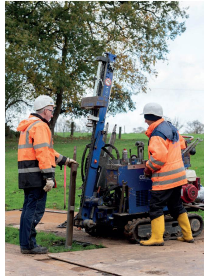
Bei der Kleinrammbohrung kommt ein Hohlgestänge zum Einsatz. Ziel: Bodenproben entnehmen.
