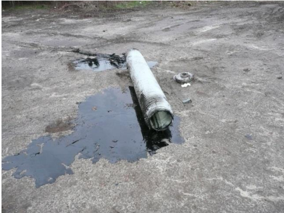
Abbildung 14: 220 kV VPE-Erdkabelfehler in Berlin-Adlershof (2008)
